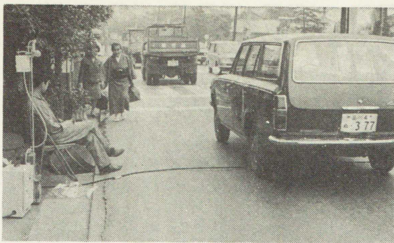
交通量の多い世田谷町田線で測定する自動車の排気ガス
